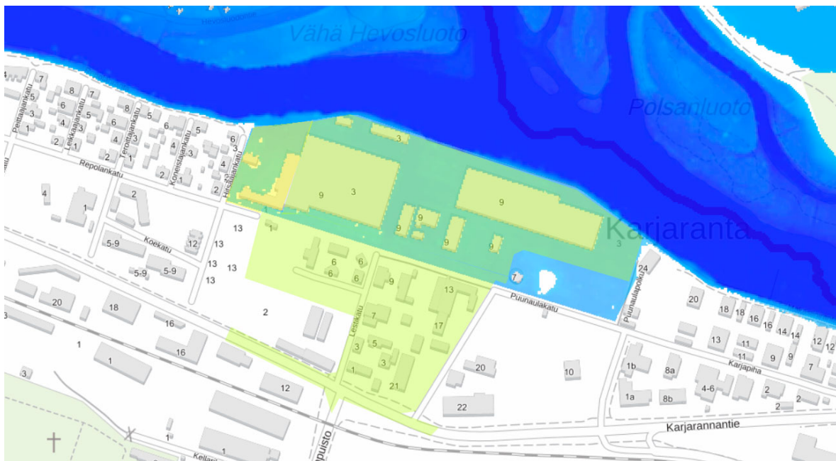
Kuva 22, tulvasuojaus tehty, vedenkorkeus +3,15 m N2000, 1/250a.
